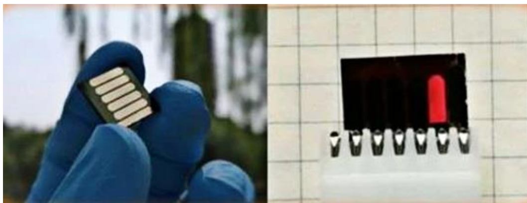
图 1. 左：反式结构钙钛矿太阳能电池。右：电池器件在正向电压（ 2\text{V} ）下的发光照片（表明电池器件具有较低的非辐射复合能量损失）。
